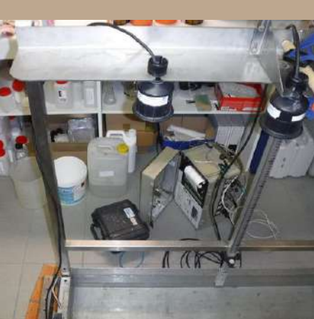
Exemple de matériel contrôlé de gauche à droite : sondes ultrasons et débitmètres, sondes de terrain, sondes piézométriques
